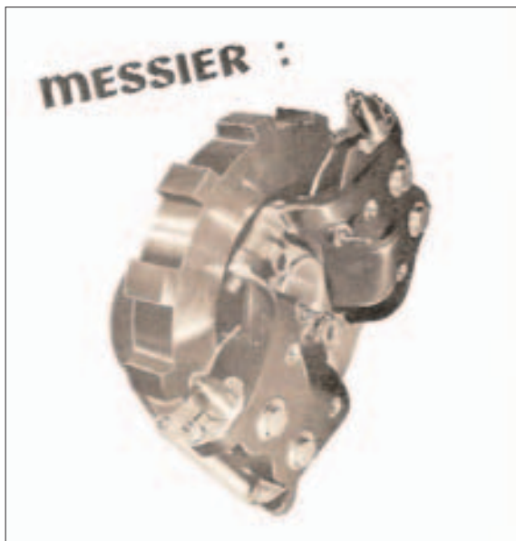
4-2 : Frein Messier à monorotor en cuivre et garnitures organiques du Mirage III C (source Messier-Bugatti)
