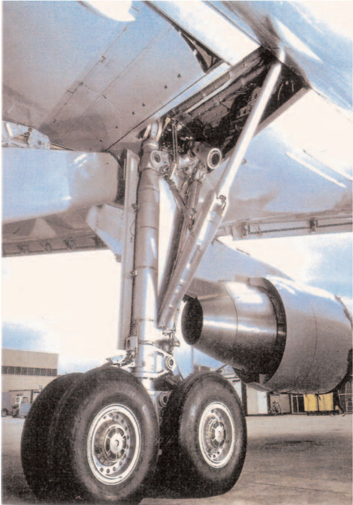
3-17 : Atterrisseur principal de l'Airbus A300 (source Messier-Dowty)
