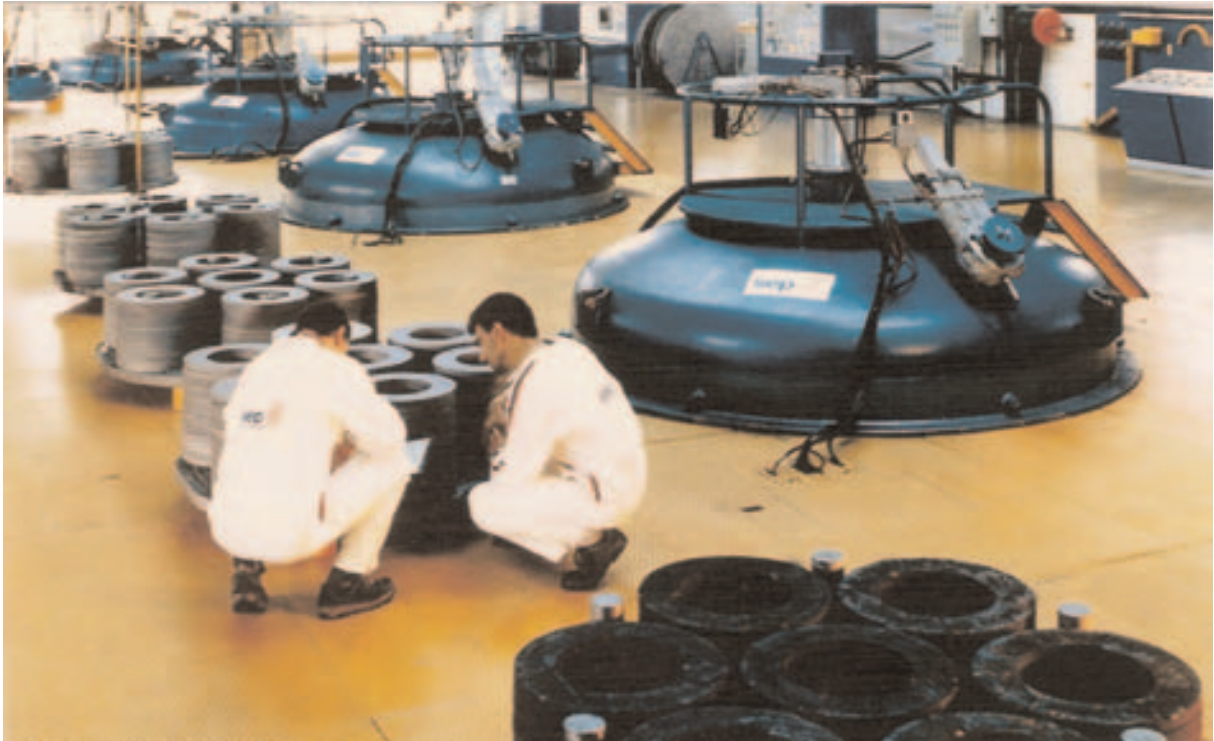
4-13 : Batterie de fours de densification chez Carbone-Industrie (source Messier-Bugatti)
