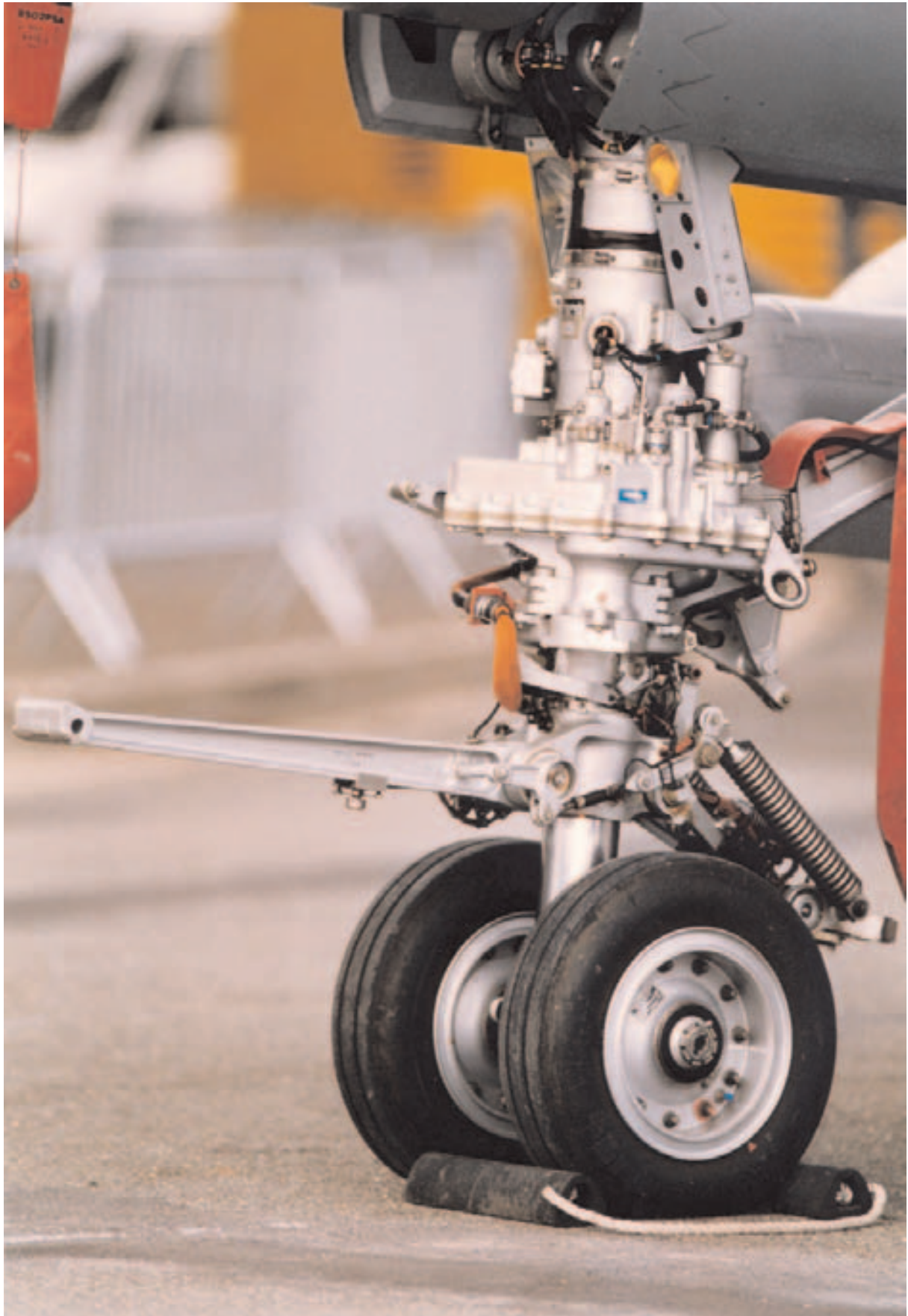
6-3 : Moteur d'orientation de roues du Rafale Marin (source Messier-Bugatti)
