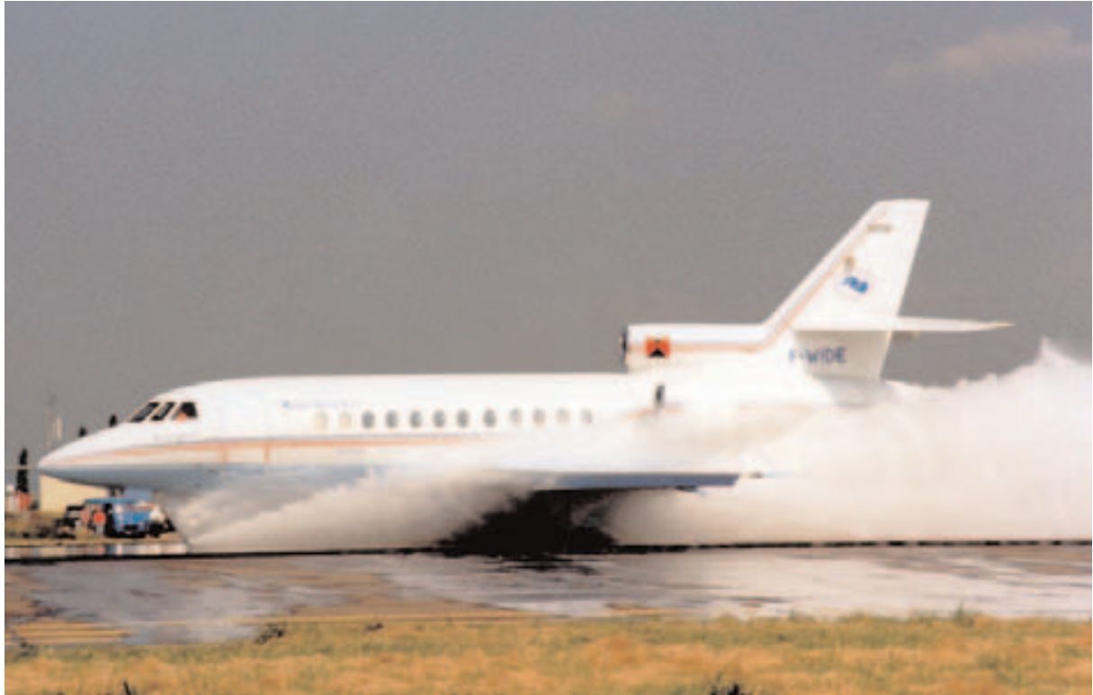
3-24 : Essai d'ingestion d'eau du Falcon 900 (source CEV de Brétigny-sur-Orge)
