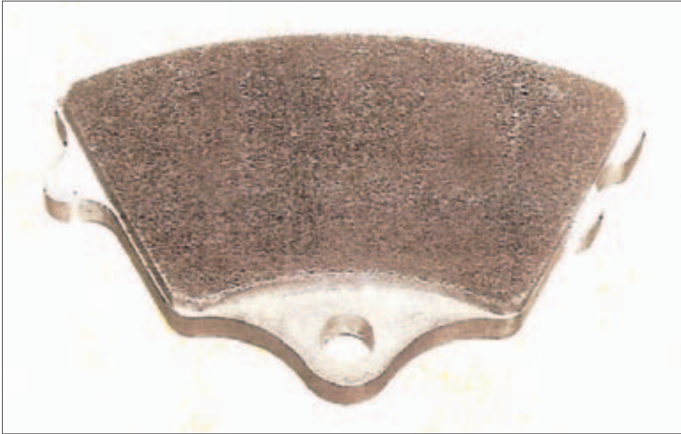
4-4 : Élément de stator du frein Messier " Tribloc " (source Messier-Bugatti)
