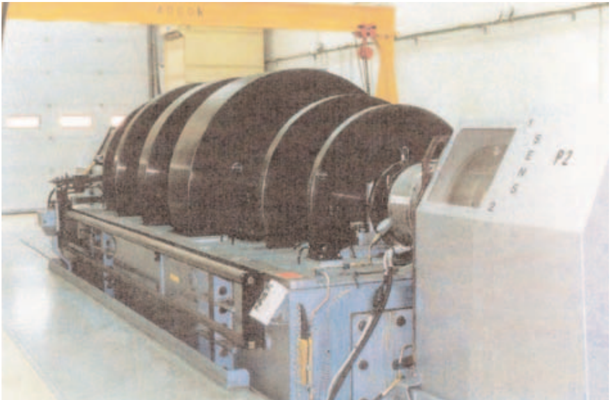
4-26 : Machine axiale d'essais de freins chez Messier-Bugatti (source Messier-Bugatti)
